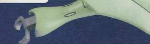
バインダーの先端に装備された簡易型のミニピュレーター。
