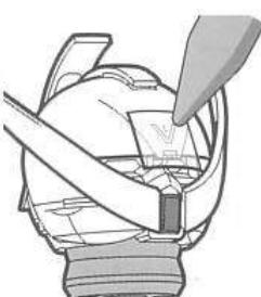
②保護シートをはがし、貼る位置を決めてから、ずれないようにセロハンテープ等で固定し、マークの上からボールペン等の先端の丸い物でこすりつけて定着せます。
